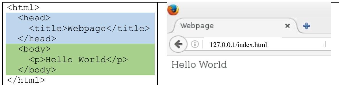
Εικόνα 1: Στα αριστερά φαίνεται αρχείο index.html με το <head> και το <body> sections. Στα δεξιά φαίνεται η απεικόνιση του αρχείου από τον φυλλομετρητή Mozilla Firefox μέσα από το VM.
